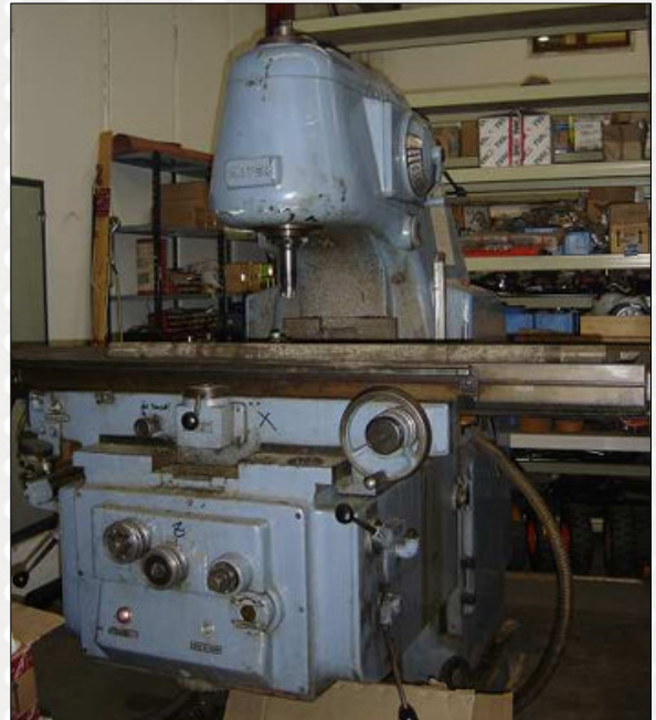
Fresadora ZAYER model 5-V Superfície de taula 2000x400mm. Motor de 15HP amb 32 velocitats, 25-1800rpm. Cono ISO-50. Equipada amb diferents conos i eines.
