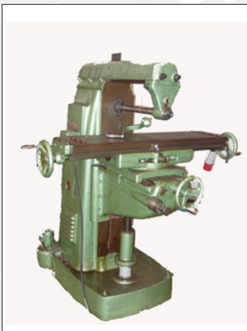
Fresadora FEXAC model UP Superfície de taula 1100x240mm. Avanços auto. amb 12 velocitats. Cono ISO-40.
