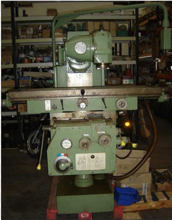
Fresadora universal LAGUN model FU-1400 Superfície de taula 1400x340mm. Motor de 6HP amb 18 velocitats, 28-1400rpm. Cono ISO-50. Equipada amb diferents conos i eines.
